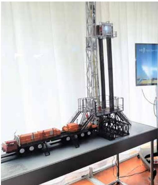
Die Firma MB Well Services ist regelmäßig mit einer sogenannten „Workover-Anlage“ im Kavernenfeld Etzel zu beobachten. Zu den 50+1-Feierlichkeiten hatte das Unternehmen ein Modell der „Rig“ T45 im Hauptzelt ausgestellt. Die selbstfahrende Anlage ist eine universell einsetzbare Anlage für Tiefbohrungen bis etwa 2.500 m und Arbeiten am Bohrloch mit Rohrein- und -ausbau („sog. Workover“). Für STORAGE ETZEL wird die T45 meist im 24-Stunden-Betrieb auf Öl- und Gaskavernen eingesetzt.
