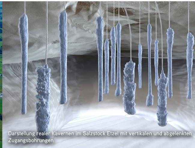
Darstellung realer Kavernen im Salzstock Etzel mit vertikalen und abgelenkten Zugangsbohrungen
